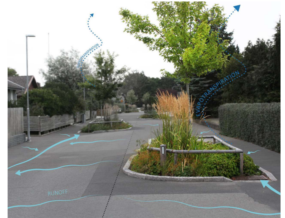
dešťový záhon - princip fungování
